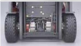
★ Administración de la potencia de los motores dobles de tracción y del motor de bomba para manejo de carga y dirección es llevada a cabo a través de control total AC. Este Sistema de Potencia AC requiere menos costos de mantenimiento que el sistema DC actualmente en uso.
